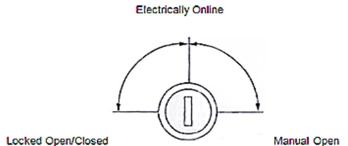
**Peringatan:** Untuk mengurangi resiko rusak atau kunci patah, jangan membiarkan kondisi terkunci selama operasional normal.
